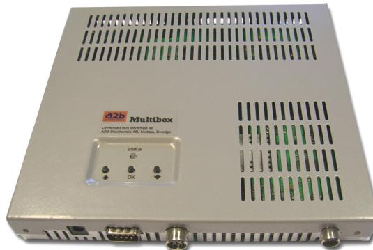
**M**ultiBox-løsningen fra **a2b**, er en smart løsning, som indeholder 2 tunere og 3 modulatorer. Den omsætter automatisk f.eks. de tre svenske frie DVB-T-kanaler, SVT1, SVT2 og TV4, til almindelige PAL-kanaler med NICAM-stereo i f.eks. S-båndet på S11, S13 og S16. Løsningen er naturligvis også velegnet til omsætning af de kommende danske frie DVB-T-kanaler: DR1, DR2 og TV2 (fra 1. april 2006).
